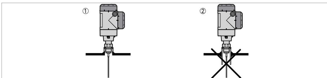
Obrázek 3-4: Návarky pro závitové provozní připojení
