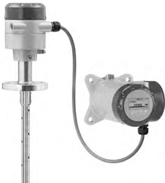
Diese Ausführung ist mit einem separaten Messumformer mit einer Anzeige ausgestattet, die unten am Tank oder sogar in einer Entfernung von bis zu 100 m / 328 ft vom Sensor montiert und abgelesen werden kann.
