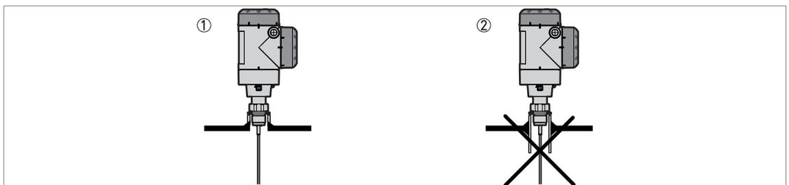
Abbildung 3-4: Muffen für Gewindeanschluss
