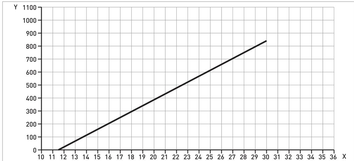
Abbildung 2-1: Mindestspannungsversorgung für einen Ausgangswert von 22 mA an der Anschlussklemme (Nicht-Ex und Zulassung für explosionsgefährdete Standorte (Ex i / IS))
