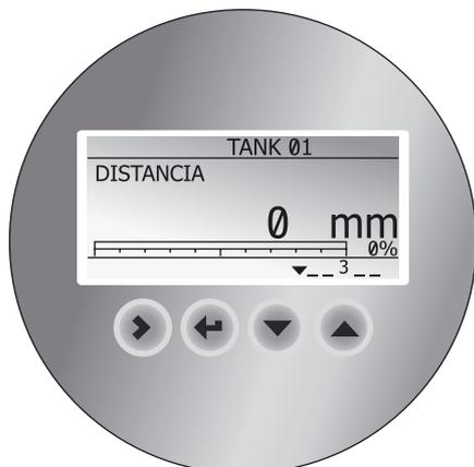
La pantalla se puede solicitar junto con el equipo o bien como accesorio. Se trata de una pantalla de 128 x 64 píxeles que muestra los datos de medida. El menú de configuración permite configurar el equipo de manera intuitiva en tan sólo unos pocos pasos.
