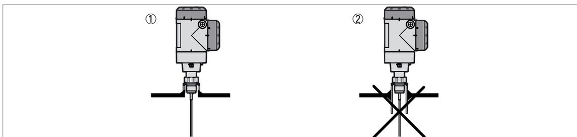
Figura 3-4: Casquillos para conexiones a proceso roscadas
