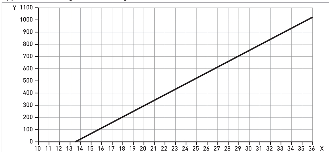
Figure 2-2: Tension minimale d'alimentation pour une sortie de 22 mA aux bornes (homologation zones dangereuses (Ex d / XP/NI))
