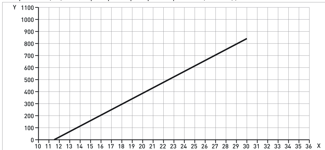
Рисунок 2-1: Минимальное напряжение питания при выходном токе 22 мА на клеммах (для приборов невзрывозащищённого исполнения и исполнения с взрывозащитой вида Ex i / IS)
