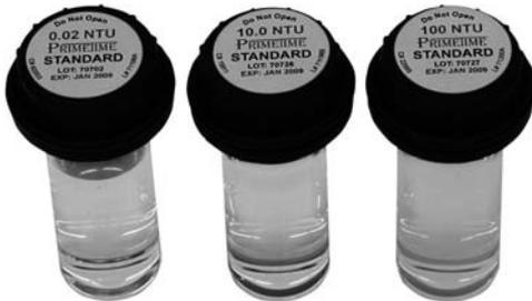
Das Kalibriererset enthält drei Küvetten mit Flüssigkeiten drei unterschiedlicher Trübungsgrade (0,02, 10 und 100 NTU/FNU). Mithilfe dieses Zubehörs können Sie in nur wenigen Minuten eine Neukalibrierung durchführen.
