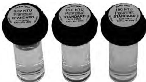
El kit de calibración contiene tres cubetas con líquidos con tres patrones de turbidez (0,02, 10 y 100 / 1000 NTU/FNU). Gracias a este accesorio se puede realizar una recalibración precisa en pocos minutos.
