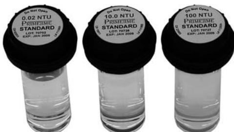
Le kit d'étalonnage est composé de trois cuvettes contenant des solutions avec trois turbidités différentes (0,02, 10 et 100 /1000 NTU/FNU). Il permet d'étalonner l'appareil avec précision en seulement quelques minutes.
