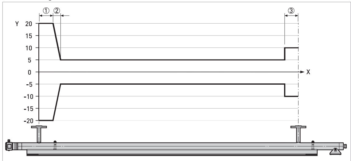
Abbildung 2-3: Messgenauigkeit / Abstand von den Prozessanschlüssen des Bezugsgefäßes in mm
