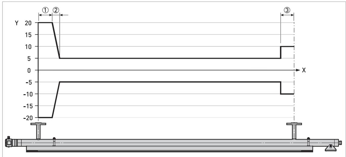
Figure 2-3: Précision de mesure / distance par rapport aux raccords process de la chambre de mesure, en mm
