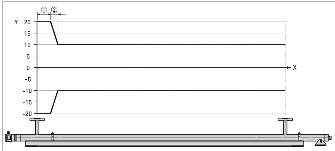
Figure 2-1: Précision de mesure / distance par rapport aux raccords process de la chambre de mesure, en mm
