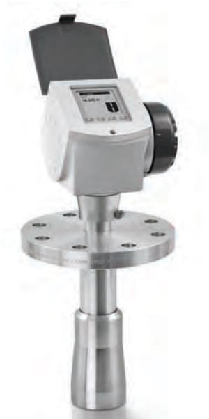
El uso de antenas cónicas de metal es recomendado para medir granulados, para aplicaciones a alta presión y alta temperatura, en obras con cemento o procesos con separadores de ciclón. Son particularmente resistentes a las sacudidas mecánicas. Tienen estas características:
