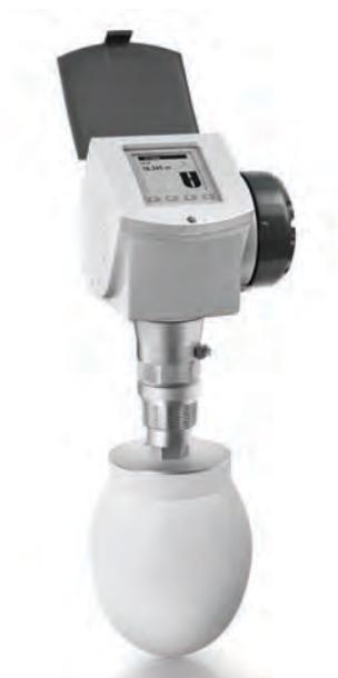
Les antennes Drop sont une innovation unique pour la mesure de poudres et d'autres solides dans des atmosphères très poussiéreuses. La forme ellipsoïde des antennes empêche toute accumulation et génère un faisceau étroit pour une mesure précise du contenu des silos. Leurs caractéristiques sont les suivantes :
