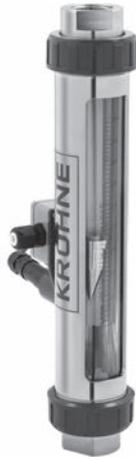
Der Grenzwertgeber MS14 wird bei allen Nennweiten eingesetzt. Der Schwebekörper wird bei Einsatz dieses Grenzwertgebers mit einem Magnet ausgestattet, der den Schaltvorgang auslöst. Der eingebaute Reedkontakt arbeitet potenzialfrei.
