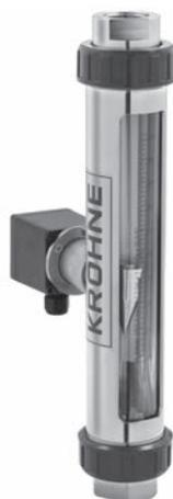
Der Grenzwertgeber TG21 wird bei den Nennweiten DN25 bis DN50 eingesetzt. Der Schwebekörper wird bei Einsatz dieses Grenzwertgebers mit einem Magnet ausgestattet, der den Schaltvorgang auslöst. Der Grenzwertgeber arbeitet mit einem 2-Leiter NAMUR Schlitzinitiator.
