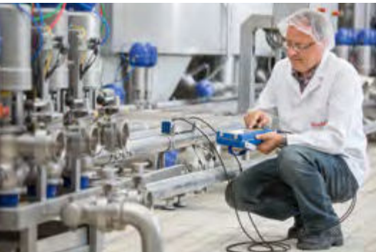
Bir süt işletmesinde kelepçeli akışölçer ile geçici akış ölçümü
