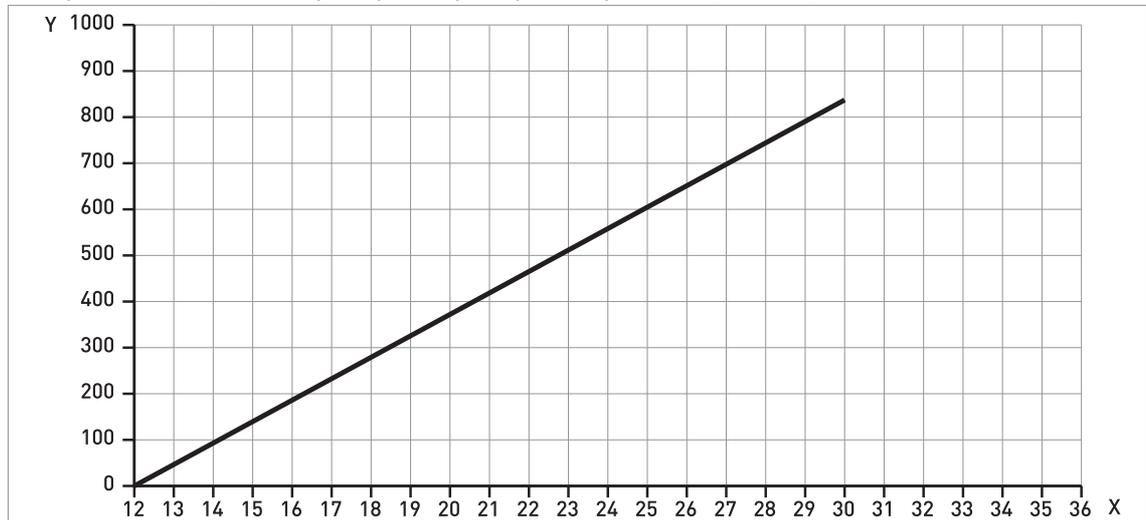
Рисунок 8-6: Минимальное напряжение питания при выходном токе 21,5 мА на клеммах (для приборов невзрывозащищённого исполнения и исполнения с взрывозащитой вида Ex i / IS)
