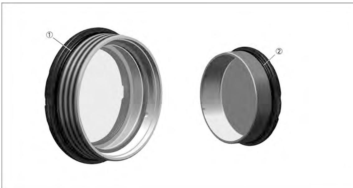
Рисунок 7-1: Обслуживание уплотнительных колец
