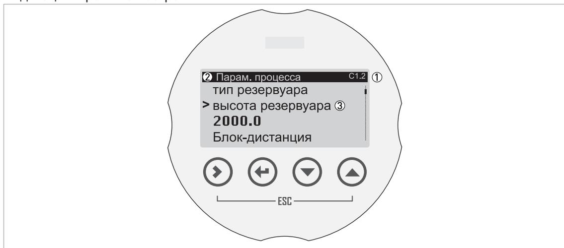
Рисунок 5-2: Расположение информации на экране дисплея в режиме настройки
