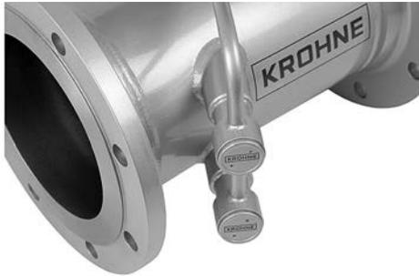
O **OPTISONIC 7300** é um medidor de vazão ultrassônico para gás com um (2" / DN50 e 3" / DN80) ou dois caminhos ( $\geq 4"$  / DN150), concebido para medir uma ampla faixa de gases e misturas de gases.
