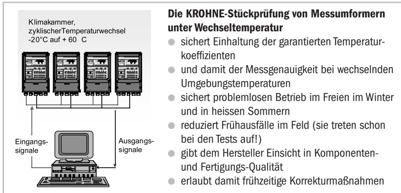
Abb. 30: Burn-in Test der Messumformer sichert hohe Zuverlässigkeit
