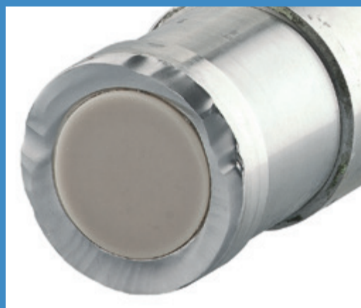
OPTIBAR PC 5060 : membrane céramique intégrée utilisée avec un produit à mesurer abrasif, car elle est dix fois plus dure que l'acier inox
