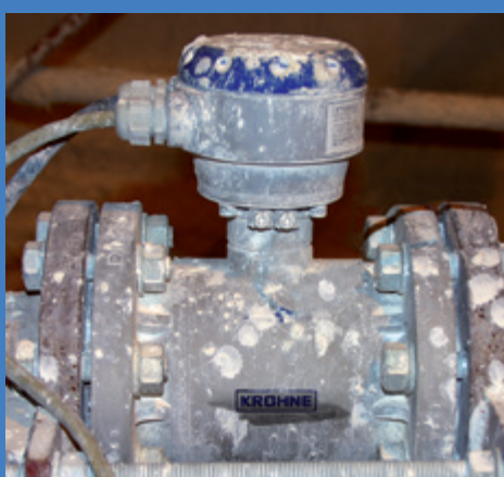
OPTIFLUX 5000: Messrohr aus Oxidkeramik bei Einsatz in der chemischen Industrie
