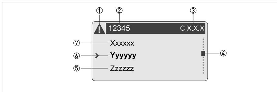
Figura 6-3: Display per la selezione del menu o delle funzioni
