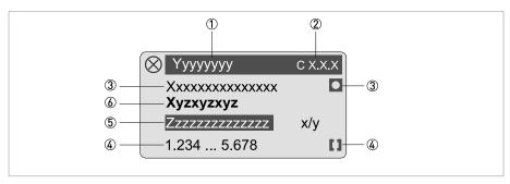
Figure 6-4: Display when setting a parameter in parameter and data mode
