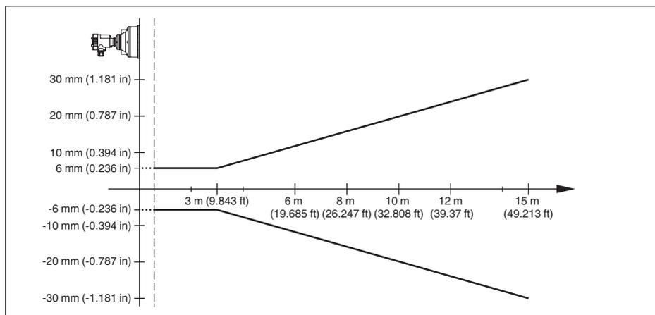
Рис. 26: Погрешность измерения OPTISOUND 3030 C
