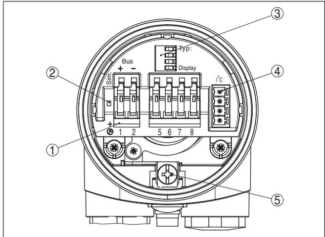
Рис. 17: Отсек электроники и подключения (однокамерный корпус)
