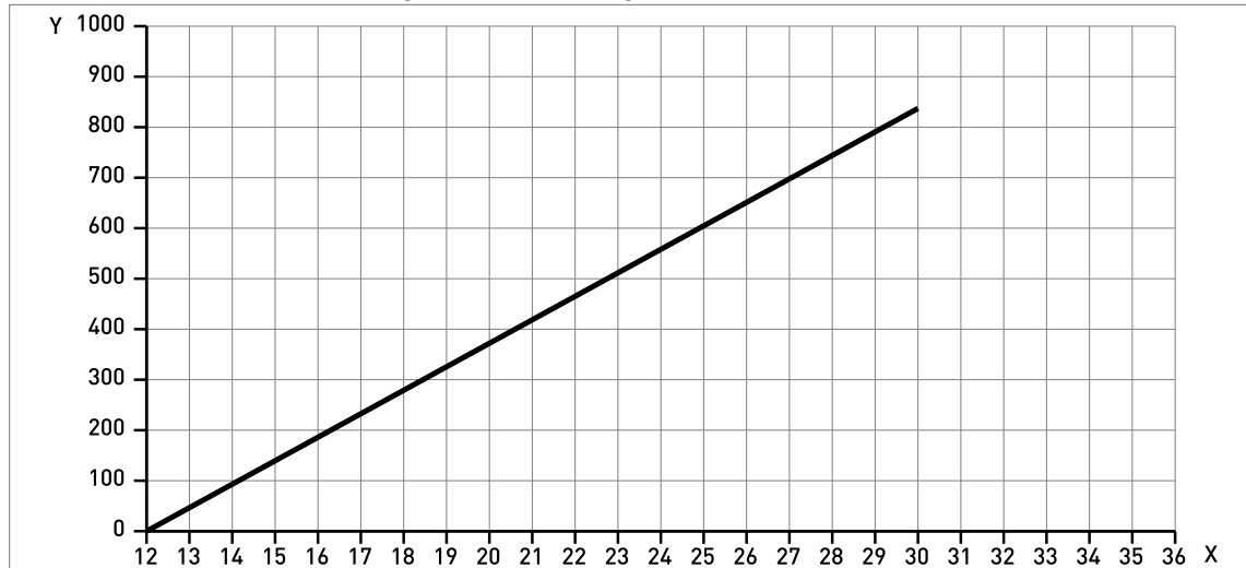
Figure 2-5: Tension minimale d'alimentation pour une sortie de 21,5 mA aux bornes (homologation non Ex et zones dangereuses (Ex i / IS))
