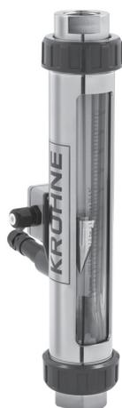
Der Grenzwertgeber MS14 wird bei allen Nennweiten eingesetzt. Der Schwebekörper wird bei Einsatz dieses Grenzwertgebers mit einem Magnet ausgestattet, der den Schaltvorgang auslöst. Der eingebaute Reedkontakt arbeitet potenzialfrei. Der Schaltvorgang ist bistabil.
