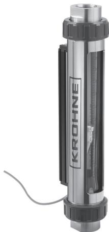
Die Linearwegsensoren WIM 160 / WIM 200 werden bei den Nennweiten DN25 bis DN50 eingesetzt. Der Schwebekörper wird mit einem Magnet ausgestattet, so dass der Linearwegsensor die Höhenstellung des Schwebekörpers erfasst und als 4...20 mA-Signal ausgibt. Eine Kalibrierkurve ermöglicht die Zuordnung 4...20 mA zu Durchflusswerten.
