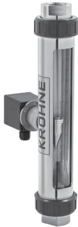
Der Grenzwertgeber TG21 wird bei den Nennweiten DN25 bis DN50 eingesetzt. Der Schwebekörper wird bei Einsatz dieses Grenzwertgebers mit einem Magnet ausgestattet, der den Schaltvorgang auslöst. Der Grenzwertgeber arbeitet mit einem 2-Leiter NAMUR Schlitzinitiator. Der Schaltvorgang ist bistabil.
